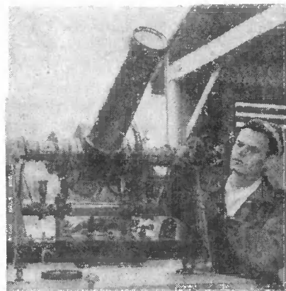
Пассажный инструмент для определения поправок часов службы времени. У инструмента — кандидат физико-математических наук Э. А. Санакулов.
